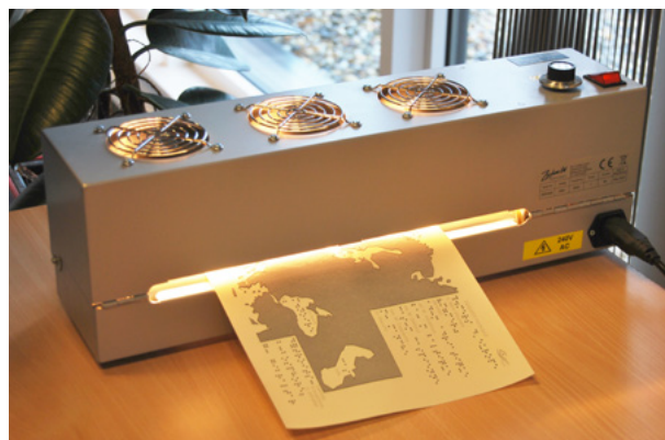
Four permettant d'obtenir des schémas en relief
